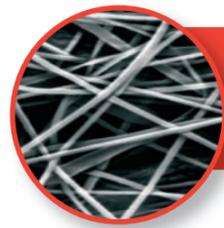
Les fibres du média filtrant Ultrafilter ne sont pas liées avec un adhésif comme c'est généralement le cas, mais thermiquement soudées. La pression différentielle est ainsi réduite et la capacité de rétention des impuretés est considérablement améliorée.
